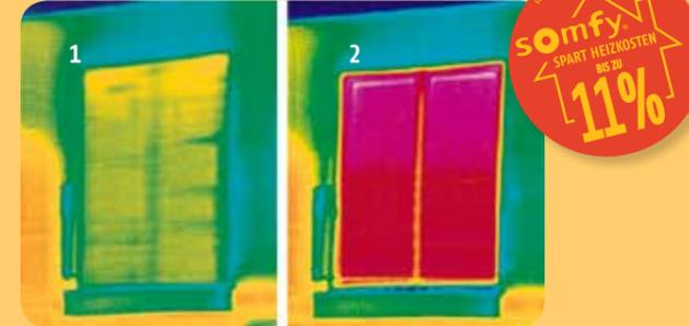
Bei einem Fenster mit geschlossenen Rollläden (1) ist die Wärmedurchlässigkeit deutlich geringer gegenüber einem Fenster mit hochgezogenen Rollläden (2).
